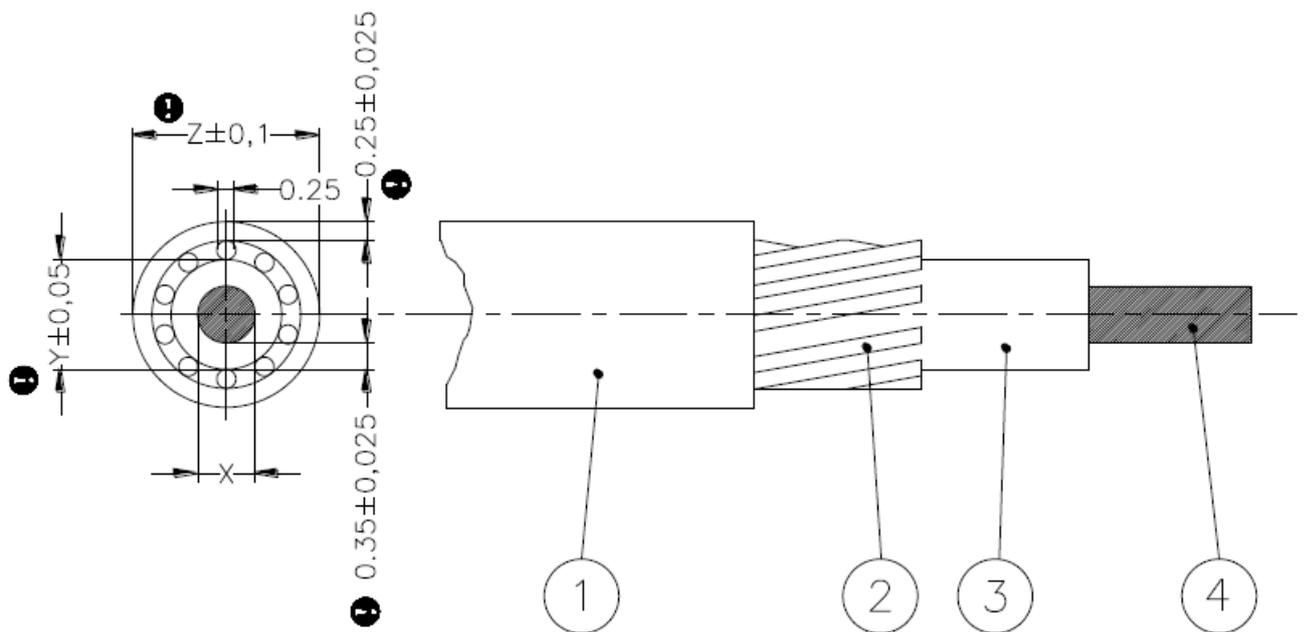
Рис. 2. Устройство нагревательного кабеля для **DEVIheat™ 150S (DSVF-150)**.
