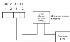
Использование цифровых выходов в качестве импульсных
