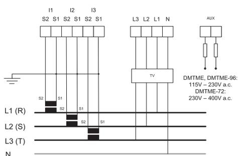
Трёхфазное подключение с использованием схемы Арона (два трансформатора тока, два трансформатора напряжения)
