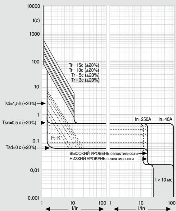
**Диапазон регулирования уставок термомангнитного расцепителя для DPX<sup>3</sup>**
