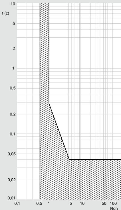
**Время-токовые характеристики выключателя DPX<sup>3</sup> 250 с электронным расцепителем**
