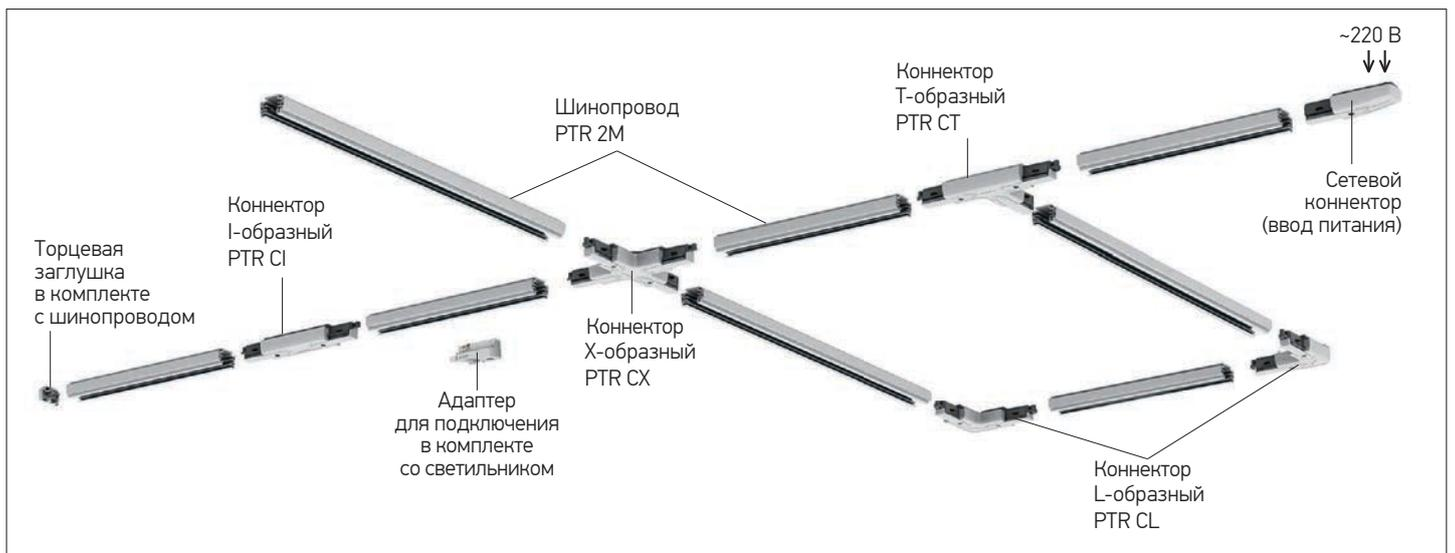
Шинопроводы используются для монтажа трековых светодиодных прожекторов **PTR jazzway**. Основной шинопровода является алюминиевый профиль, который крепится напрямую к потолку или подвешивается. С помощью коннекторов из шинопроводов можно собрать осветительную систему любой конфигурации.
