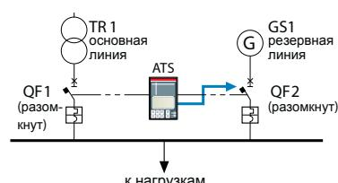
Блок ATS передаёт команду на размыкание выключателя QF2.
