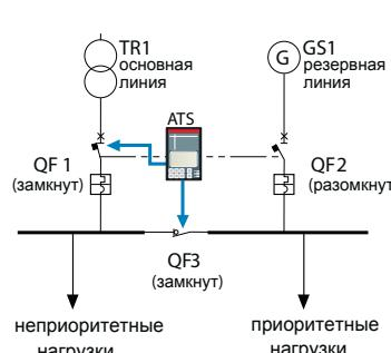
Блок ATS передаёт команду на замыкание выключателя QF1 и QF3.
