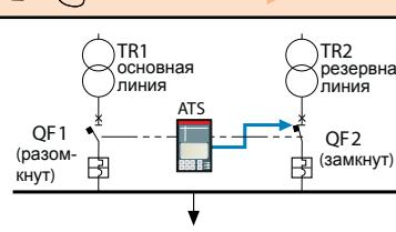
Блок ATS передаёт команду на замыкание выключателя QF2 резервной линии питания.
