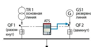
Блок ATS передаёт команду на замыкание выключателя QF2.
