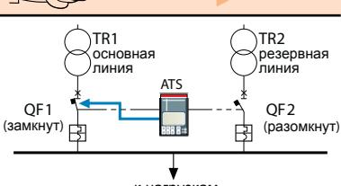
Блок ATS передаёт команду на замыкание выключателя QF1 основной линии питания.
