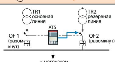
Блок ATS передаёт команду на размыкание выключателя QF2 резервной линии питания.
