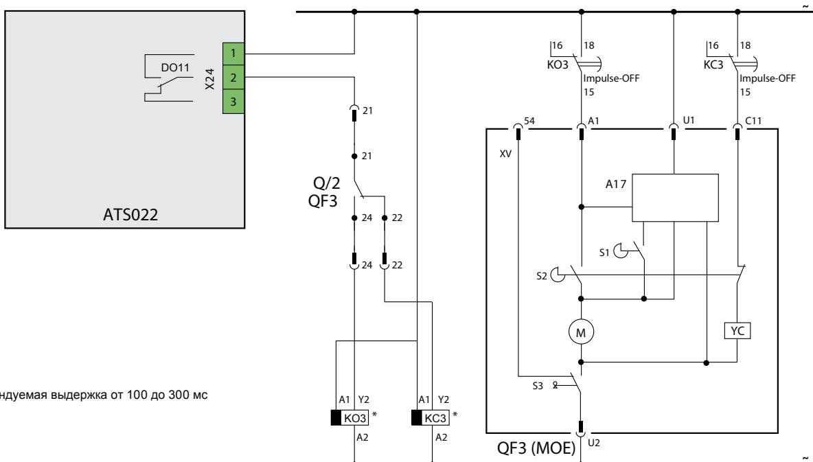
Полностью выполнив все подключения цепей управления и контроля к блоку ATS022, необходимо задать верные настройки в самом блоке (напряжение системы, количество фаз, схема работы с секционным выключателем). Затем необходимо настроить времена выдережек.
