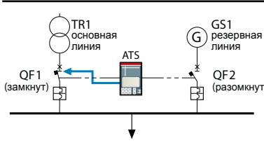
Блок ATS передаёт команду на замыкание выключателя QF1.
