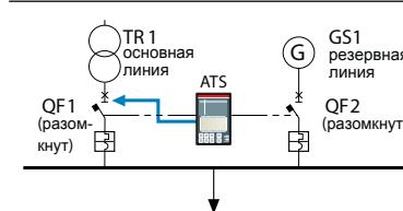
После восстановления питания на резервной линии, блок ATS подаёт команду на размыкание выключателя QF1. После размыкания QF1 ATS отсчитывает время задержки TCE (TF для ATS021).
