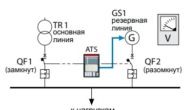
Блок ATS передаёт команду на останов генератора.
