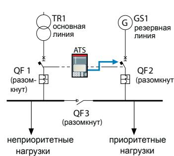
Блок ATS передаёт команду на размыкание выключателя QF2.
