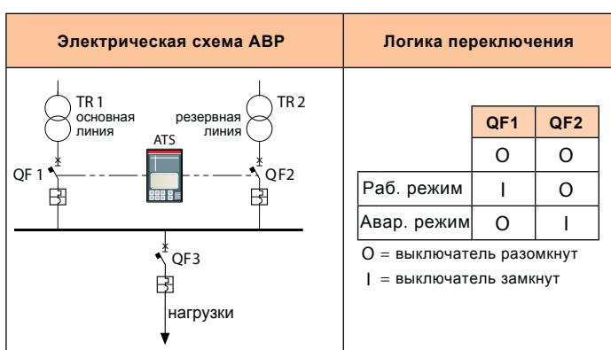
При рабочем режиме схемы, блок ATS контролирует питание основной сети; в случае аварии, ATS передаёт сигнал на размыкание выключателя QF1 основной линии питания спустя время задержки TS. Если питание резервной линии находится в установленных пределах, то блок передаёт команду на замыкание выключателя резервной линии с выдержкой TCE (TF для ATS021).
