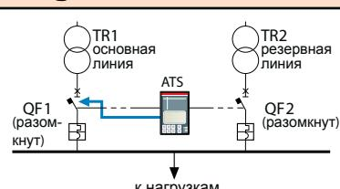
ATS передаёт команду на размыкание выключателя QF1 основной линии питания.
