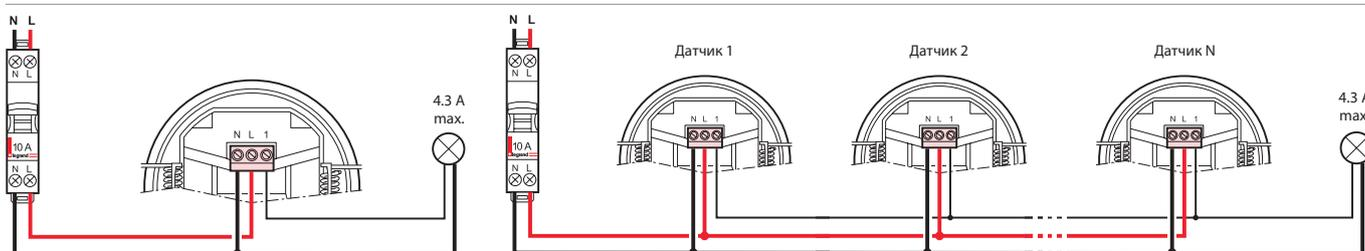
Датчики подключаются по простой трехпроводной схеме с нейтралью. Возможно также параллельное подключение датчиков для управления общей нагрузкой.
