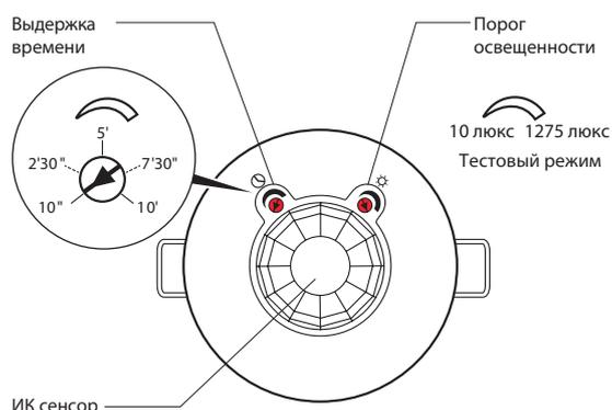
Установка основных параметров работы датчика осуществляется с помощью поворотных регуляторов на корпусе устройства.
