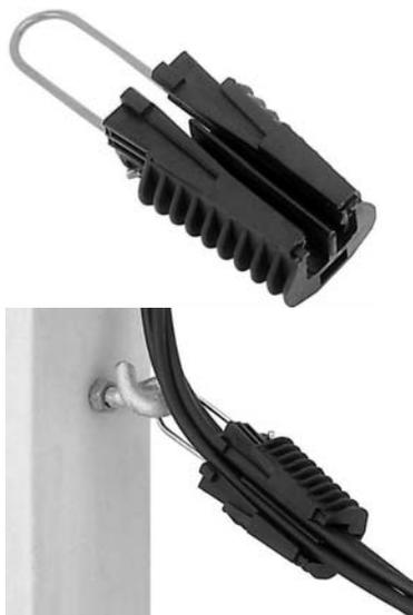
Анкерные зажимы применяются для выполнения абонентских ответвлений 2-мя или 4-мя проводами одинакового сечения. Скоба съемная. МРН $\geq$ 3,5 кН.
