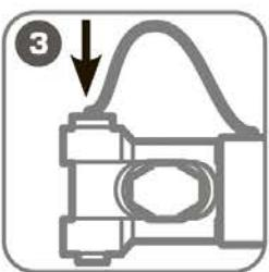
**Вставьте упорный штифт в рабочую головку до срабатывания фиксатора**
