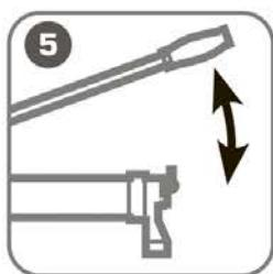
**Создайте помпой давление в гидроцилиндре. Опрессыте изделие**
