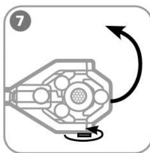
Поверните винт фиксации откидной головы, и снимите инструмент с кабеля.
