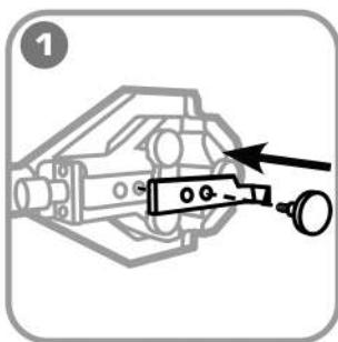
Установите нож для снятия полупроводящего слоя.
