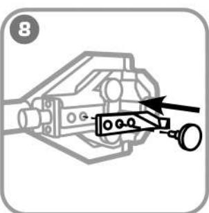
Установите нож для снятия изоляции из СПЭ.
