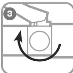
Поверните винт сброса давления в положение «Закрыть».
