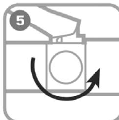
Поверните винт сброса давления в положение «Открыть».
