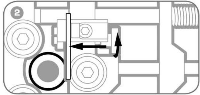
Вращая регулировочный винт, настройте нож на глубину срезаемого слоя.
