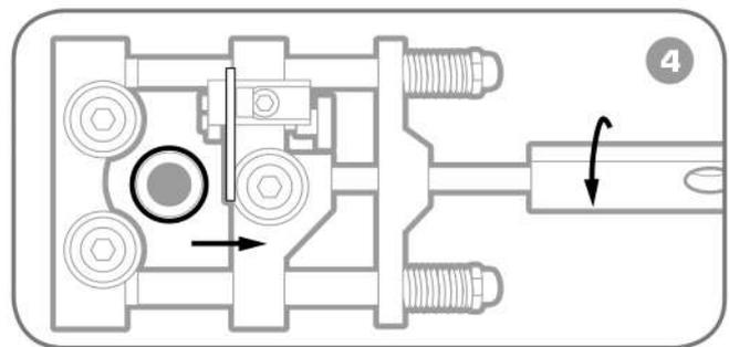
Вращая рукоятку инструмента, отведите каретку на достаточное расстояние. Аккуратно снимите инструмент с кабеля, оберегая его от случайных повреждений и задиrow поверхности.
