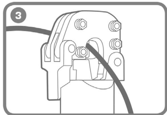
**Нажмите на кнопку «ПУСК» и держите до срабатывания механизма автоматического сброса давления. При этом раздается характерный щелчок.**
