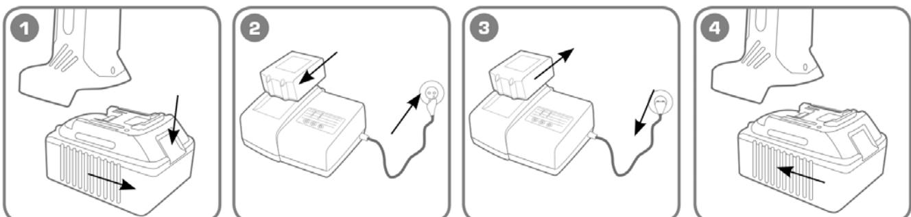
**Для снятия аккумулятора, нажмите на фиксатор и выньте его из корпуса инструмента.**
