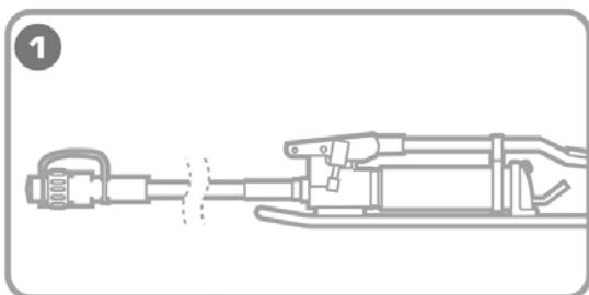
**Установите помпу и ножницы по возможности на ровной, плоской поверхности. Такое положение обеспечит устойчивость во время работы**
