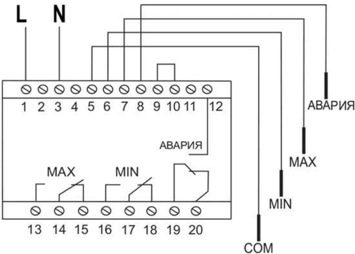
Отключить питание, подключить автомат в соответствии со схемой подключения. Для контроля по минимальному уровню надо аварийный уровень (Авария) подключить к зажиму 9, перемычка между клеммами 9-10 не устанавливается, зонд аварийного уровня ниже общего (COM). Если аварийный уровень выше максимального, то установить перемычку между клеммами 9 и 10, зонд аварийного уровня выше максимального (MAX).
