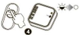
Нажать и затем отпустить эту же кнопку передатчика. Светодиод зажжется (пульсирующий сигнал), а затем потухнет - ПЕРЕДАТЧИК СОХРАНЕН.
