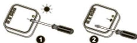
Нажать кнопку PROG устройства ROP-03 и удерживать ее до момента зажжения (постоянный сигнал) красного светодиода. Затем отпустить кнопку PROG.
