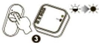
Нажать и затем отпустить кнопку передатчика. Зажечется (пульсирующий, а затем постоянный сигнал) красный светодиод.
