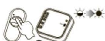
Нажать и затем отпустить кнопку передатчика. Зажжется (пульсирующий, а затем постоянный сигнал) красный светодиод.
