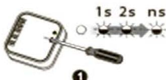
Нажать и затем отпустить кнопку PROG устройства ROP-04. Светодиод потухнет, а потом зажжется (пульсирующий сигнал). Каждая пульсация светодиода означает 1 секунду.
