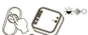
Нажать и затем отпустить эту же кнопку передатчика. Светодиод зажжется (пульсирующий сигнал), а затем потухнет - ПЕРЕДАТЧИК СОХРАНЕН.
