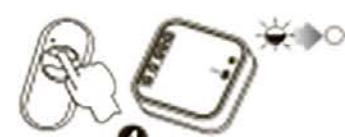
Нажать и затем отпустить эту же кнопку передатчика. Светодиод зажжется (пульсирующий сигнал), а затем потухнет - ПРЕДАТЧИК СОХРАНЕН.
