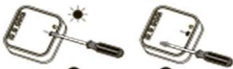
Нажать и удерживать кнопку PROG устройства SLR-01 до момента зажжения (постоянный сигнал) красного светодиода. Затем отпустить кнопку PROG.
