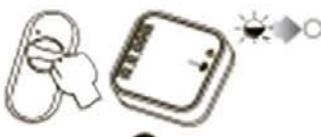
Отпустить кнопку передатчика. Светодиод зажжется (пульсирующий сигнал), а затем потухнет - ПРЕДАТЧИК СОХРАНЕН.
