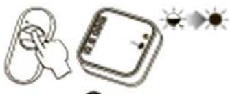
Нажать и удерживать кнопку передатчика. Зажжется (пульсирующий, а затем постоянный сигнал) красный светодиод.
