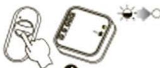
Нажать и отпустить вторую кнопку передатчика. Светодиод зажжется (пульсирующий сигнал), а затем потухнет - ПРЕДАТЧИК СОХРАНЕН.
