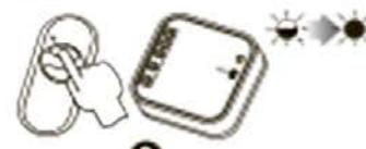
Нажать и отпустить первую кнопку передатчика. Зажжется (пульсирующий, а затем постоянный сигнал) красный светодиод.
