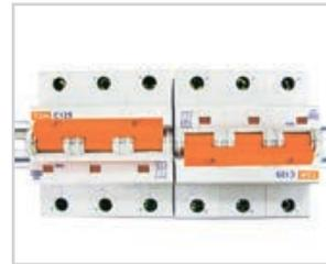
**Могут устанавливаться в любом положении** без изменения их номинальных характеристик. Подвод питающей линии может производиться как через верхние, так и через нижние клеммы без нарушения работоспособности.
