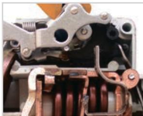
**Механизм «моментного» включения** позволяет исключить возможность «плавного» смыкания силовых контактов при взведении рукоятки управления, что существенно продлевает срок службы контактов.
