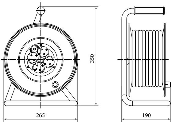
Удлинитель силовой, 40, 50 м, 4 места с проводом ПВС 3x1,0 мм<sup>2</sup> и ПВС 3x1,5 мм<sup>2</sup>
