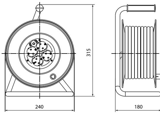
Удлинитель силовой, 30 м, 4 места с проводом ПВС 3x1,0 мм<sup>2</sup> и ПВС 3x1,5 мм<sup>2</sup>
