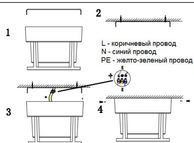
1. Отсоедините основание светильника от его корпуса, выкрутив сбоку два удерживающих винта. Для этого используйте шестигранный ключ на 2.
