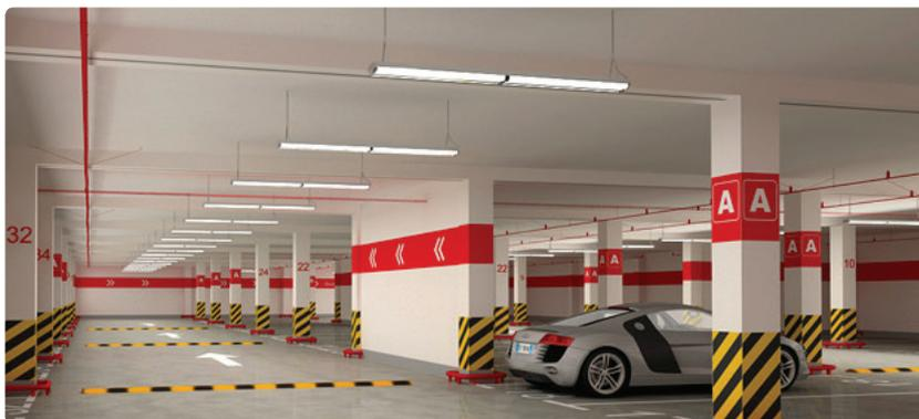
Светодиодные пылевлагозащищенные энергосберегающие светильники Navigator серии DSP-AC-40-LED (аналог ЛСП) – эффективная замена традиционных люминесцентных светильников. Идеально подходят для освещения промышленных, коммерческих и муниципальных объектов с высотой потолков до 6 метров.
