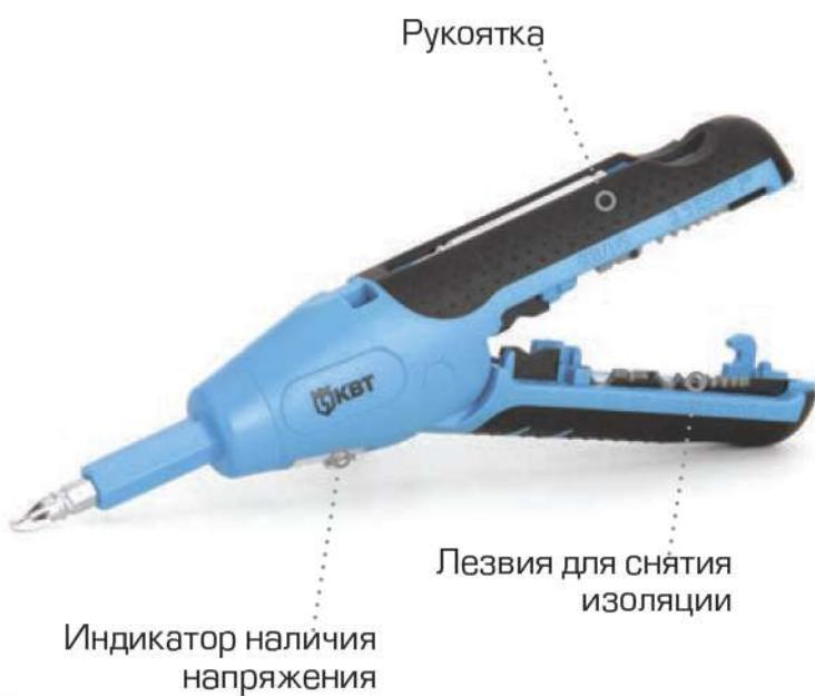
Ручной стриппер WS-05 состоит из двухкомпонентной, раскрывающейся рукоятки, моногпозиционных лезвий для резки и разделки кабеля/провода, наконечника для установки отверточных бит и индикатора наличия напряжения в сети
