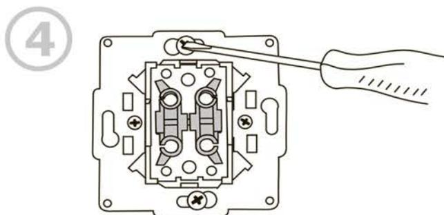
Установить механизм изделия в углублении стены, зафиксировать стопорные винты, затянув их до упора.
