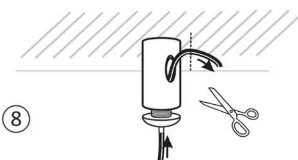
Для регулировки высоты подвесного троса необходимо выкрутить зажимную цангу на втулке, подтянуть трос до необходимой высоты и закрутить цангу. Далее обрезать остаток троса, выходящий из втулки потолочного крепления.
