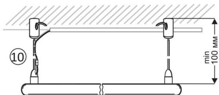
Рекомендуемое минимальное расстояние между обогревателем и потолком min 100мм.
