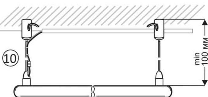
Рекомендуемое минимальное расстояние между обогревателем и потолком min 100мм.
